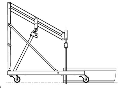
élingue stable appropriée dans l'anneau de suspension de la charge et est soulevé à la hauteur correspondante pour pouvoir être saisi par la fourche de tête. Cette hauteur varie si la fourche de tête est directement utilisée dans le logement de l'élévateur à bras en porte-à-faux ou si l'adaptateur (réf. 12374) est utilisé pour une hauteur de levage totale de 3,0 m (voir ci-dessous). Le support soulevé doit être posé sur un appui suffisamment stable (par ex. des tréteaux d'échafaudage).
