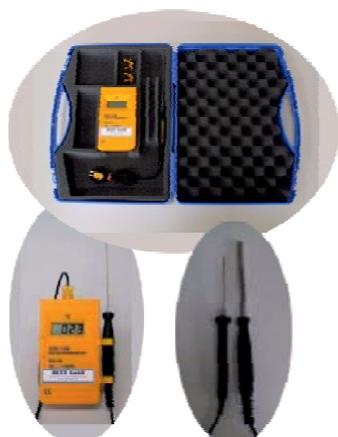
Pour effectuer des mesures de contrôle de la température des gaz et du fer à souder, ainsi que la température du matériau d'apport pour la soudure ; Requis selon la directive DVS 2207-4.
