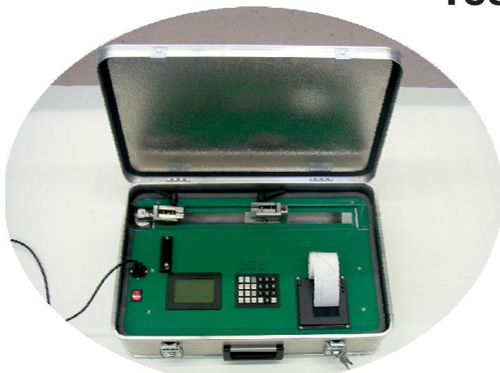
Les appareils de contrôle de la régularité **Teston** et **Teston Mini Digital** sont des appareils de contrôle compacts pour contrôler les soudures sur chantier et/ou en atelier, sur des panneaux d'étanchéité en matière plastique et du point de vue du lissage, de la coupe et de la régularité.
